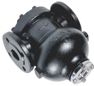
fig SK55 vlotter-condenspot PN16 DN32 - DN50 flens huis : nodulair gietijzer GGG40.3 RVS vlotter en binnenwerk temp. : max. +250°C voorzien van borosilicaat kijkglas ingebouwde thermostatische ontlufter delta P : 4,5 bar / 10 bar / 14 bar horizontale montage
