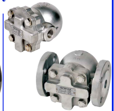
fig SK61 RVS vlotter-condenspot PN25 1/2" - 1" bsp / DN15 - DN25 flens huis : RVS 316 (CF8M) RVS vlotter en binnenwerk temp. : max. +250°C ingebouwde thermostatische ontlufter delta P : 4,5 bar / 10 bar / 14 bar horizontale montage
