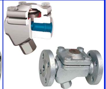
fig TKK2Y thermostatische condenspot PN40 1/2" - 1" bsp / DN15 - DN25 flens huis : staal A105 RVS/hastelloy binnenwerk voorzien van Y-filter max. druk P1 : 32 bar max. verschildruk delta P : 22 bar temp. : max. +250°C horizontale montage
