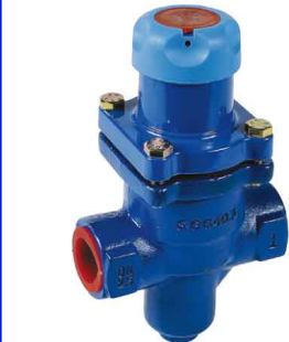
fig 930 drukreducerendventiel PN25 1/2" - 1" bsp type BDV25 geschikt voor stoom - lucht - gassen huis : nod. gietijzer GGG40.3 RVS binnenwerk ingebouwde filter temp. : max. +210°C max. druk P1 : 17 bar instelbaar : 0,14 - 1,7 / 1,4 - 4,0 / 3,5 - 8,6 bar
