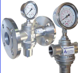
fig 931 RVS drukreducerendventiel 1/2" - 1" bsp type PRV-S voorzien van manometer diam. 63 mm huis : RVS 316 (CF8M) dichtingen in viton/teflon druk P2 : max. 80 % van druk P1 temp. : max. +192°C / max. druk P1 : 12 bar instelbaar : 1,0 - 6 bar / 4,0 - 10 bar fig 932 idem met flenzen PN16
