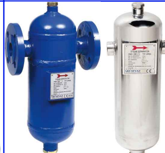
waterafscheiders/droger voor stoom en perslucht fig SPR40 DN15 - DN100 PN40 huis : staal max. druk : 32 bar / temp. : max. +250°C fig SPR25 1/2" - 1" bsp PN25 huis : RVS 304 max. druk : 25 bar / temp. : max. +228°C
