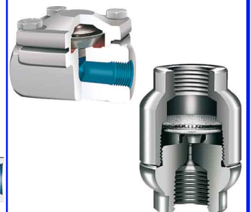
thermostatische condenspot fig TKK21 staal / PN25 1/2" bsp huis : staal A105 RVS binnenwerk voorzien van ingebouwde filterzeef max. druk P1 : 21 bar / temp. : max. +250°C fig TKK42 inox / PN40 1/4" - 1" bsp max. druk P1 : 32 bar / temp. : max. +240°C max. verschildruk delta P : 22 bar
