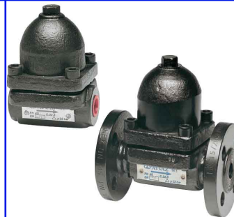
fig TK1 bi-metaal condenspot PN40 1/2" - 1" bsp / DN15 - DN25 flens huis : staal A105 RVS binnenwerk voorzien van Y-filter en terugslagklep max. druk P1 : 32 bar max. verschildruk delta P : 22 bar temp. : max. +250°C montage in elke positie
