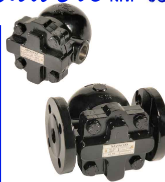
fig SK70 stalen vlotter-condenspot PN25 1/2" - 1" bsp / DN15 - DN25 flens huis : staal A216WCB RVS vlotter en binnenwerk temp. : max. +400°C ingebouwde thermostatische ontlufter delta P : 4,5 bar / 10 bar / 14 bar horizontale montage
