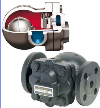
fig SK51 vlotter-condenspot PN16 1/2" - 1" bsp / DN15 - DN25 flens huis : nodulair gietijzer GGG40.3 RVS vlotter en binnenwerk temp. : max. +250°C ingebouwde thermostatische ontlufter delta P : 4,5 bar / 10 bar / 14 bar horizontale montage
