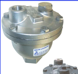
ontluchters 3/4" bsp fig PF20 : huis in gietijzer max. druk : 10 bar temp. : max. +120°C fig AV02 : huis in RVS max. druk : 12 bar temp. : max. +200°C
