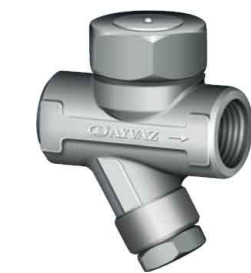
fig TDK71 thermodynamische condenspot PN63 1/2" - 1" bsp huis : RVS A743 RVS binnenwerk voorzien van Y-filter druk P2 : max. 80 % van druk P1 temp. : max. +400°C max. druk P1 : 42 bar horizontale montage
