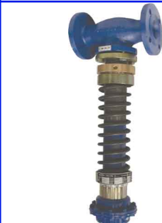
fig 934 drukreducerendventiel DRP40 DN40 - DN100 flens PN40 huis : staal / balg : RVS temp. : max. +215°C max. druk P1 : 20 bar max. verschildruk delta P : 10 bar instelbaar : 0,2 - 1,5 bar / 1 - 4 bar 1,2 - 6,0 bar / 1 - 10 bar 8,0 - 13 bar
